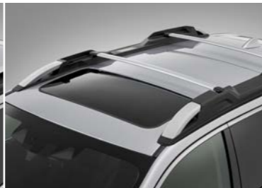
Jumta slīdes ar iebūvētiem nolokāmiem šķērsstieniem*1
