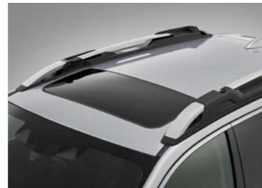
Jumta slīdes ar iebūvētiem nolokāmiem šķērsstieniem*1
