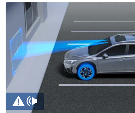
Pirmssadursmes gāzes pedāļa kontrole
